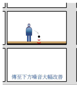
施作靜音樓板墊後，物體撞擊之振波被靜音樓板墊吸收，達到靜音效果。
